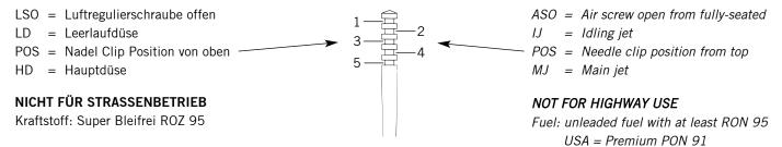
EXC/EXC-E Modelle: Die oben angeführten Vergaserregulierungen gelten nur für entdrosselte Motorräder.
